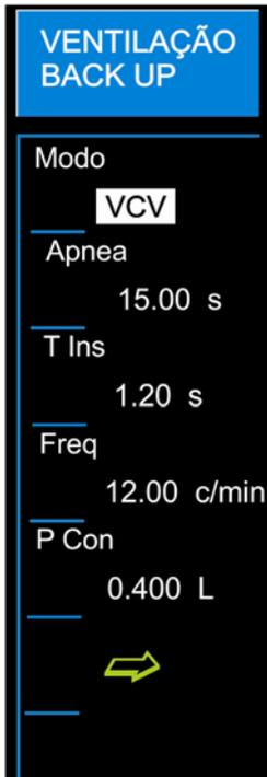
Quando o modo de ventilação selecionado é o PSV/CPAP o respirador fornecerá diretamente a tela de configuração da Ventilação de Respaldo.
