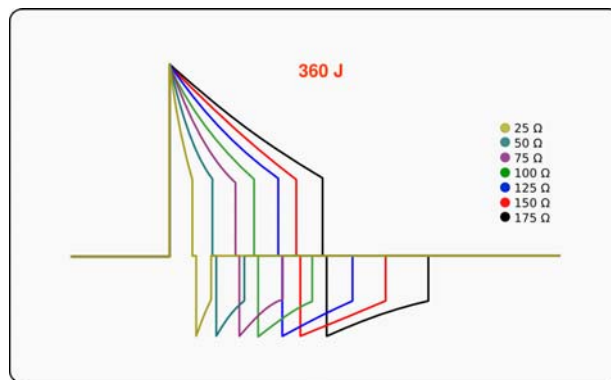
Figura 5.5 - Diferentes larguras de pulso de acordo com a impedância transtorácica.
