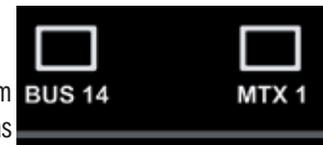
1. Pressione a tecla MTX1. Observe que os potenciômetros mudaram para o modo BUS e mudaram de cor já que agora eles são as remessas dos buses para Matrix Out 1 enquanto as teclas ON são agora o encaminhamento ON/OFF dos buses para a Matriz. Observe também que a tecla SEL sobre o potenciômetro SEL/ MONO está acesa e o brilho mudou para laranja. Este agora é o potenciômetro Master MTX1.
