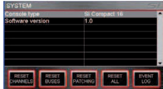
**RESET CHANNELS (restaurar canais):** Restaura todos os parâmetros de áudio de Canal de Entrada, nome do canal e tipo (MONO/LINKED) para as configurações de fábrica.
