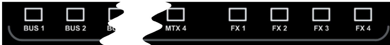
Essas teclas colocam o console no modo “MIX” permitindo uma mixagem fácil e rápida dos canais para os Buses, dos Canais para o FX ou dos Buses para a Matrix. Ao pressionar qualquer tecla é iniciada uma sequência de eventos que reconfiguram a superfície de controle e o sistema de monitoramento do console para o layout ideal para a função solicitada/desejada.
