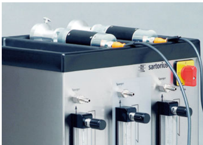
Figura 3-3: Armazenamento do motor na unidade de alimentação
