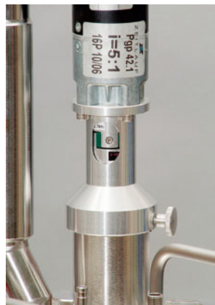
Encaixar e fixar o motor no acoplamento
