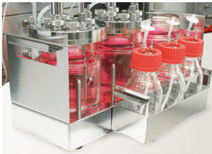
Figura 1-9: Console para recipientes com suporte para frascos e frascos de meios de correção
