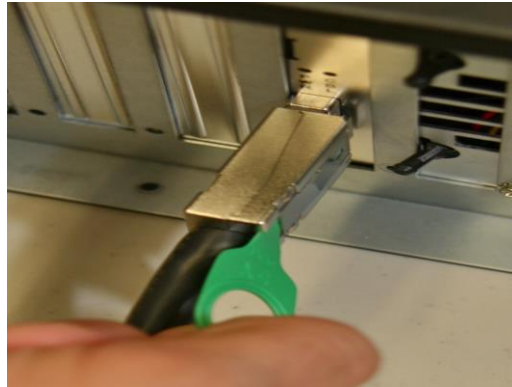
Figura 6: Conexão do cabo PCI Express
