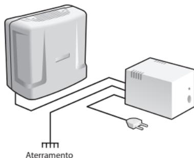
A central pode ser ligada em 110 ou 220 V (50/60 Hz). A seleção da tensão é automática. Para evitar a interrupção do funcionamento da central de portaria, indica-se a utilização de um nobreak ou shortbreak.
