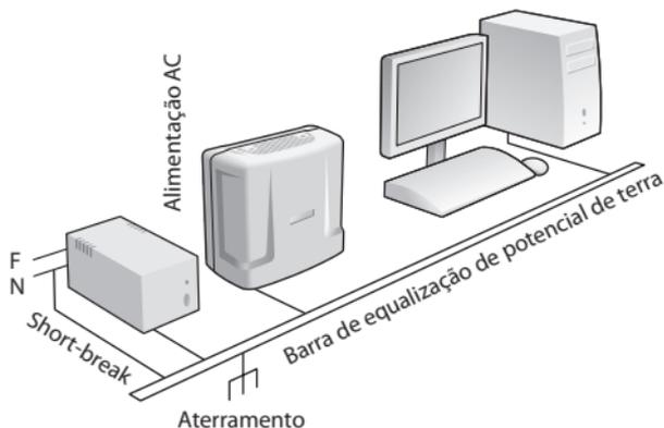
A forma ideal para o aterramento da central é a criação de uma barra de equalização de potencial de terra. Nessa barra, deve estar ligado o neutro da energia elétrica, o terra da central, as proteções da entrada AC, as proteções dos troncos e ramais e o fio terra de qualquer outro equipamento ligado à central.
