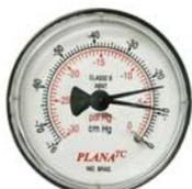
A leitura ficará abaixo do normal, mas estável entre 12 e 16 cmHg. Acelere o motor a 2.000 RPM e depois desacelere rapidamente, o ponteiro deverá pular de 2 a 5 cmHg acima da leitura obtida. Uma leitura baixa pode significar defeitos nos anéis,
