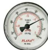
3 - Para um motor em condições normais, o vácuo se situará entre 16 e 22 cmHg, porém nos motores modernos, devido a maior quantidade de válvulas e mecanismos acionados por vácuo, os valores podem ser menores. O importante no diagnóstico é reconhecer as falhas do motor pelas indicações do ponteiro.
