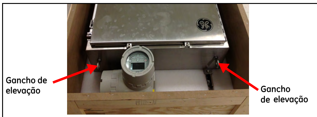
Figura 3: Erga o Aurora Trace acima do piso com os dois ganchos mostrados
