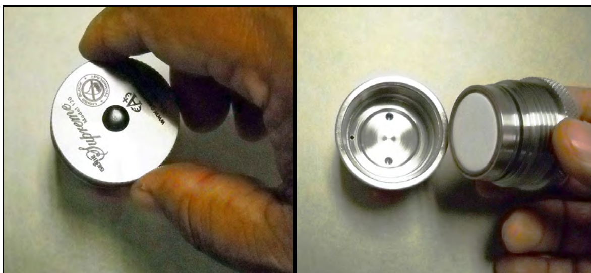
Figura 66: Remover a tampa do filtro
