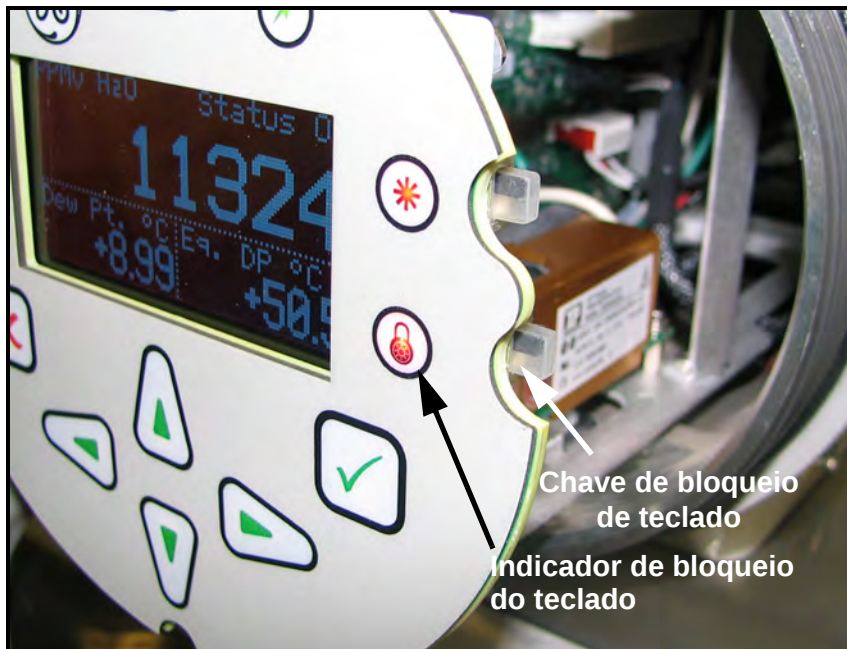
Figura 22: Localização de chave de bloqueio de teclado
