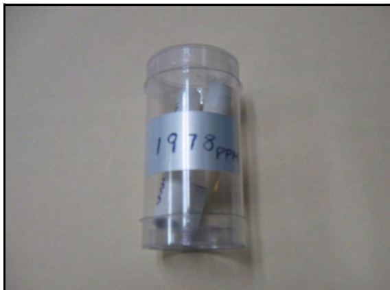
Figura 86: Novos Tubos de Permeação
