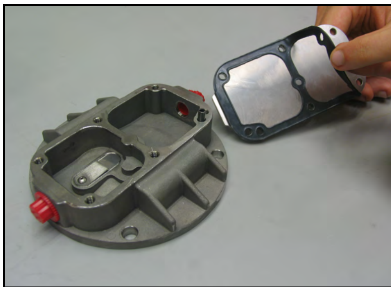
Figura 74: Remover a gaxeta da tampa da válvula
