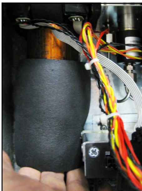
Figura 90: Instalar o isolamento
