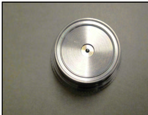
Figura 69: Remova o pequeno anel de retenção.
