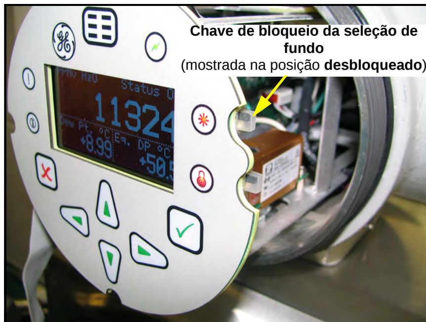
Figura 97: Localização da Chave de Bloqueio de Seleção de Fundo
