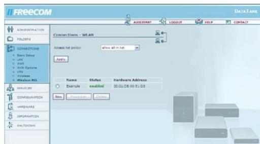
3. Agora você está novamente na página Wireless ACL onde poderá ou permitir a conexão ao seu dispositivo definido mediante "allow all in list" ou recusar a mesma com "deny all in list". Mediante um clique em "Apply", suas definições são definitivamente confirmadas.
