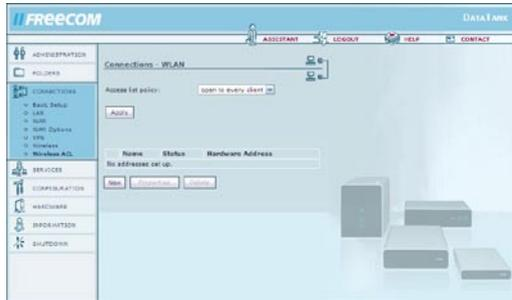
1. Vá até o ponto de menu "Wireless ACL". Mediante um clique em "New" é possível adicionar dispositivos para liberação ou restrição.
