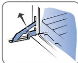
Segure a porta pelas laterais e feche-a lentamente até que se perceba uma certa resistência; neste ponto, force e, ao mesmo tempo, levante a porta em direção ao alto, de modo a liberar o encaixe da dobradiça do corpo do fogão e retire-a.
