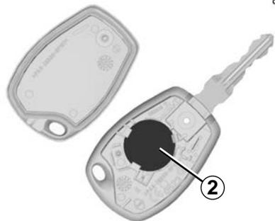
Substitua a bateria **2** observando a polaridade gravada na tampa.
