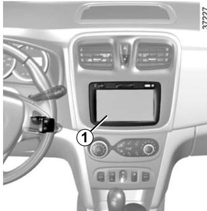
Ao ligar o veículo, o sistema de navegação leva alguns segundos para inicializar. Este funcionamento é normal e pode retardar a exibição do ambiente traseiro externo no visor ao engatar a marcha ré.
