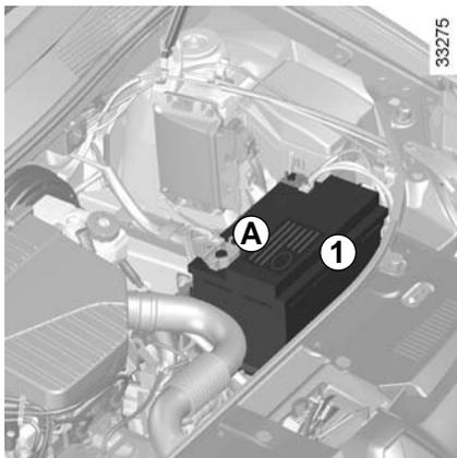
A bateria **1** não necessita de manutenção.
