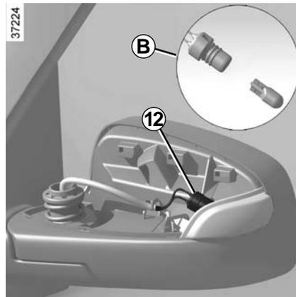
Desplugue o soquete do repetidor **12**, como indicado em **B** e substitua a lâmpada.
