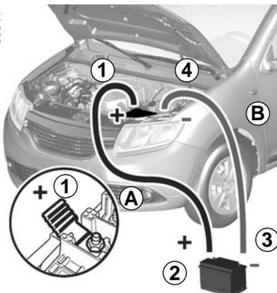
Fixe o cabo positivo (+) **A** ao borne (+) **1** da bateria descarregada, depois ao borne (+) **2** da bateria de alimentação de corrente.
