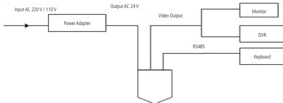
Esquema de conexão
