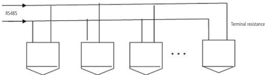
Topologia de conexão das câmeras speed dome
