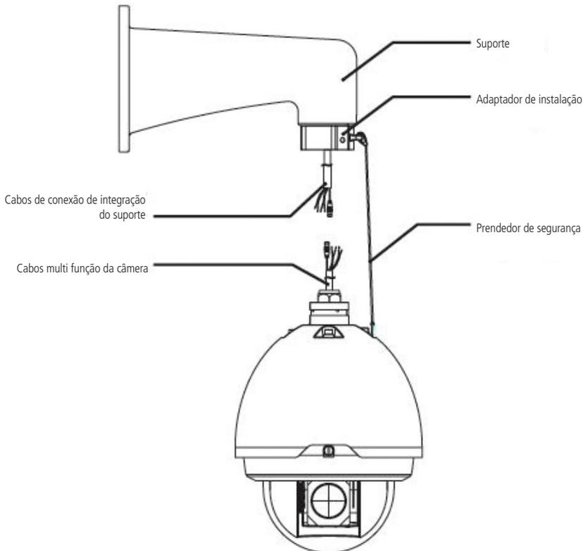
*Cabos de conexão com o suporte*
