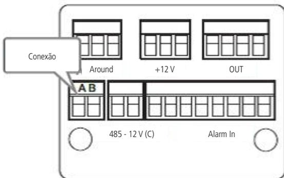
Conexão dos cabos posteriores
