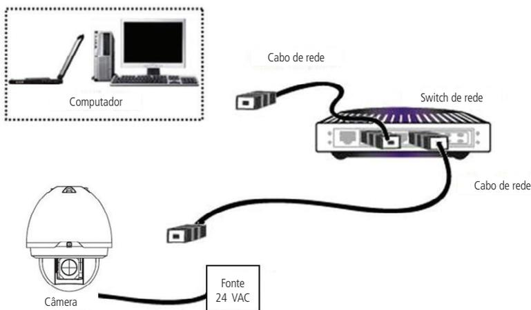
Conexão através de Switch
