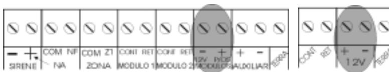
Os módulos de alta tensão devem ser alimentados por este borne ligue o pólo negativo(-) no negativo do módulo, e o pólo positivo(+) no positivo do módulo.
