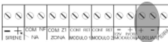
Esta saída é utilizada para alimentar sensores de infravermelho.
