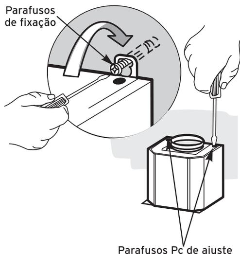
Fig. 7: Encaixe e ajuste da coifa
