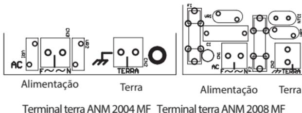
Conecte o respectivo terminal ao "terra" de sua instalação elétrica.
