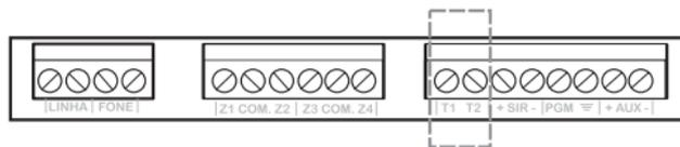
Este borne é o barramento digital utilizado para controlar os teclados e receptores de dispositivos sem fio.
