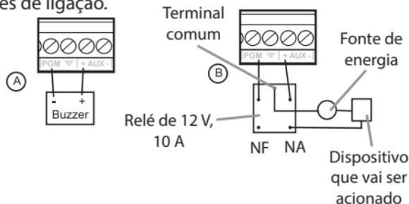
Figura A: ligação de um dispositivo que funcione em 12 V e consuma no máximo 50 mA como por exemplo um buzzer ou um LED (para ligar um LED é necessário colocar um resistor de 1 k $\Omega$  em série para limitar a corrente).
