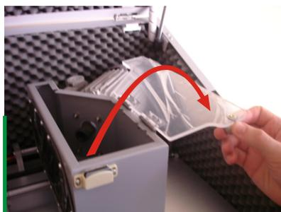
4- Abra a Tampa do Coletor de Resíduos até seu curso máximo, para facilitar a fixação da Ferramenta, conforme imagem ao lado.
