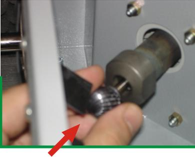
9- Coloque a Ferramenta, empurre a mesma no sentido da seta, conforme imagem ao lado, até tocar no fundo do suporte.
