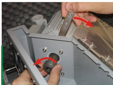
5- Com auxílio de uma Chave de Boca 19mm, retire a Porca de Aperto, conforme imagem ao lado, girando a mesma no sentido anti-horário e o Eixo do Motor no sentido contrário.
