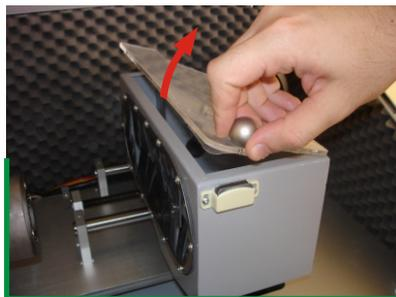
3- Abra a Tampa do Coletor de Resíduos, conforme figura ao lado, segurando pela Esfera de Manuseio da Tampa.
