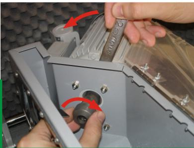
8- Com auxílio de uma Chave de Boca 19mm, encaixe a Porca de Aperto no Suporte da Ferramenta e gire no sentido horário, conforme imagem ao lado. Não é necessário apertar até o Final, pois no próximo passo, colocaremos a Ferramenta na Pinça da Ferramenta.
