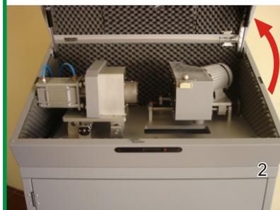
1- Para ter acesso a Mecanismo de Usinagem, e poder posicionar e fixar a Ferramenta, pressione a Tranca no sentido indicado na seta (fig. 1), e em seguida levante a Tampa de Manutenção (fig.2).
