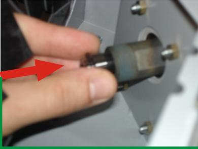
6- Encaixe a Pinça no o Cone de Centragem do Suporte da Ferramenta.
