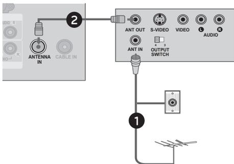
2. Usando o cabo RF (não fornecido) conecte-o na conexão **ANT. OUT** do VCR, em seguida conecte-o na conexão **ANTENNA IN** da TV.
