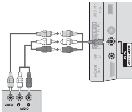
Conecte o cabo **P2** à entrada **AV IN 2 (VIDEO - AMARELO)** e **ÁUDIO - VERMELHO** e **BRANCO** da TV. Após conectar o cabo na TV efetue a conexão do equipamento externo.
