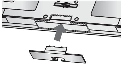
Ao remover a base, para instalar o aparelho na parede, melhore a visualização instalando a **TAMPA DE PROTEÇÃO**. Posicione a tampa corretamente e pressione-a levemente (ao ouvir um clique) para encaixá-la.
