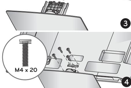
2. Encaixe o **SUPORTE** à **BASE** usando os parafusos fornecidos.
