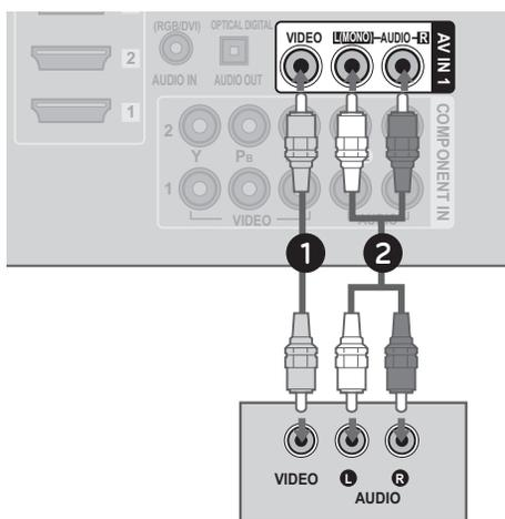
3. Após a conexão ligue os aparelhos. Na TV pressione **INPUT** e selecione sua conexão **AV** correspondente.
