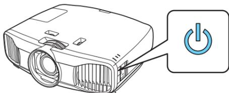
**Observação:** Para desligar o projetor, aperte duas vezes o botão de energia no projetor ou o botão **Standby** no controle remoto e depois desconecte o projetor da tomada. Não é preciso esperar o projetor esfriar.
