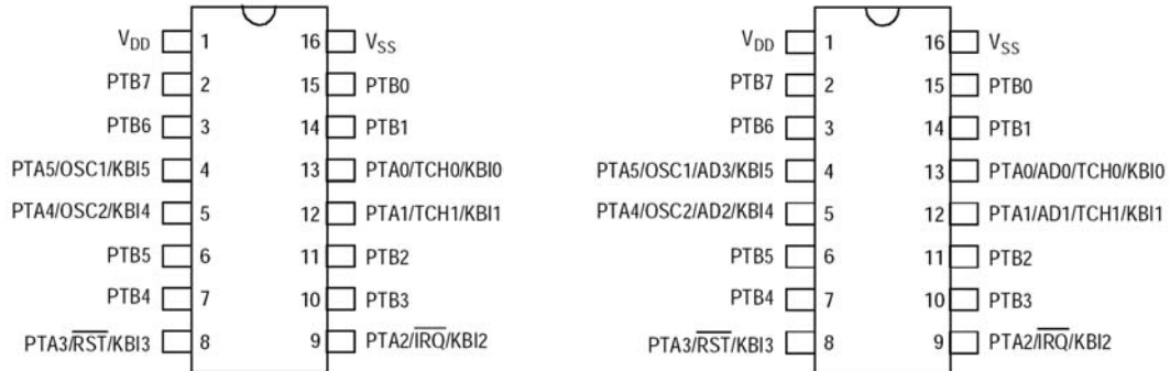
Figura 9 – Pinagem dos microcontroladores MC68HC908QY1/QY2/QY4 – PDIP/SOIC
