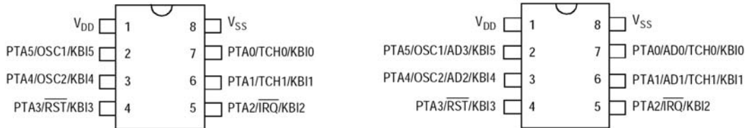
Figura 8 – Pinagem dos microcontroladores MC68HC908QT1/QT2/QT4 – PDIP/SOIC
