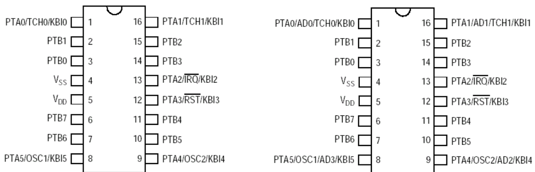
Figura 10 - Pinagem dos microcontroladores MC68HC908QY1/QY2/QY4 – TSSOP
