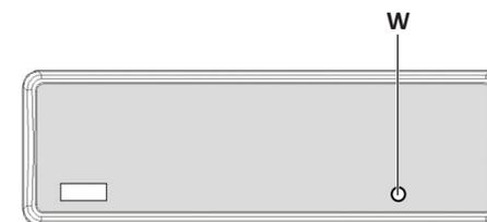
O AR-561 deve ser reinicializado em três condições: ① Depois de efetuadas todas as conexões e antes de ligar o aparelho pela primeira vez; ② Se as teclas não estiverem funcionando; ③ A tela mostrar uma indicação de erro.
