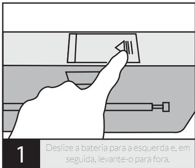
**1** Deslize a bateria para a esquerda e, em seguida, levante-o para fora.
