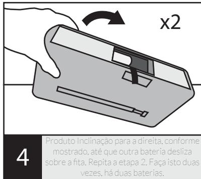
**4** Produto inclinação para a direita, conforme mostrado, até que outra bateria desliza sobre a fita. Repita a etapa 2. Faça isto duas vezes, há duas baterias.
