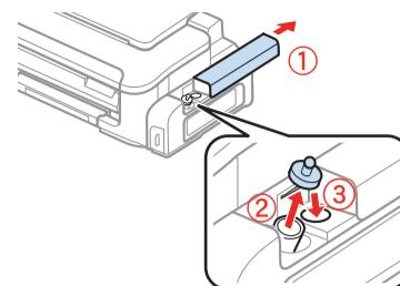
Abra a unidade do tanque de tinta e depois remova a tampa.
