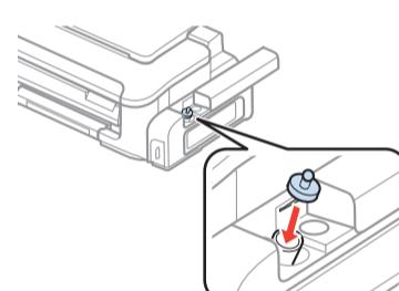
Encaixe a tampa do tanque firmemente.
