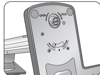
Rode o suporte para a esquerda para alinhar a seta na extremidade do suporte com a seta na base do monitor (1). Levante a cobertura do parafuso manual (2) e aperte-o tal como ilustrado (3). A seguir, volte a colocar a cobertura no lugar.
