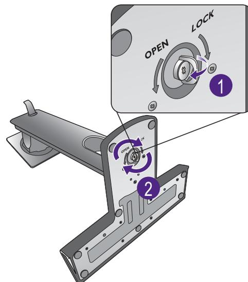
Oriente e alinhe o braço da base com o monitor (1) e empurre-os conjuntamente até que se encaixem e travem (2).
