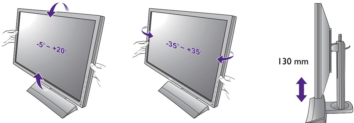
(Para o XL2720) Pode colocar o ecrã no ângulo desejado através de uma inclinação possível de  $-5^{\circ}$  a  $+20^{\circ}$  do monitor,  $90^{\circ}$  de rotação do monitor (total para a esquerda e direita) e 140 mm de altura do monitor.
