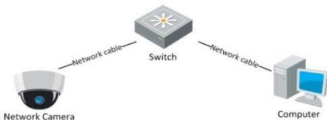
Figure 3-1 Cabeamento da rede LAN
