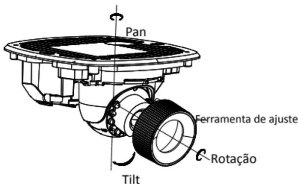
Figure 2-7 3-Ajuste de Eixo
