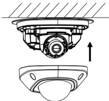
Figure 2-8 Instale a proteção frontal
