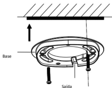
Figure 2-4 Base de fixação
