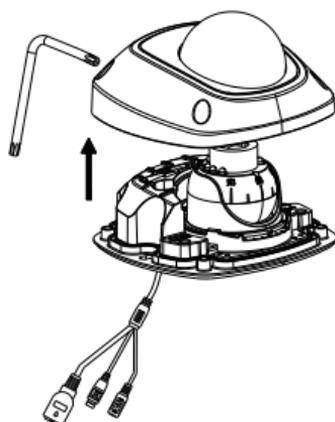
Figure 2-3 Desmontando a Câmera
