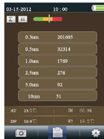
Pressione o botão RUN/STOP (executar/parar) para iniciar a bomba de ar e o processo de medição da contagem de partículas. Quando o tempo de amostragem programado tiver decorrido, o ciclo de medição irá terminar automaticamente e os dados de medição serão automaticamente armazenados. Para definir o tempo de amostragem (taxa), consulte a seção MODO DE CONFIGURAÇÃO da Contagem de Partículas. Se desejado, pressione o botão RUN/STOP (executar/parar) e pare a sessão manualmente.
