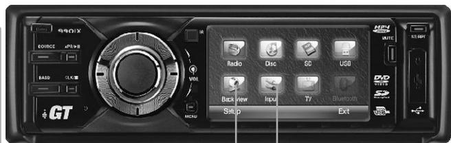
**BACK VIEW:** Sistema de entrada de vídeo através de câmera para auxílio de estacionamento, assim visualizando na tela a imagem captada pela câmera. É possível acessar a função manualmente a qualquer instante pressionando o botão SOURCE e no MENU PRINCIPAL pressione o ícone BACKVIEW na tela, também é acessado automaticamente ao engatar a marcha ré. Para usufruir da função é necessário adquirir uma câmera específica para a função. Câmera não inclusa (opcional).
