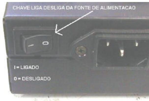
2. Conecte o cabo AC da fonte à rede elétrica.
