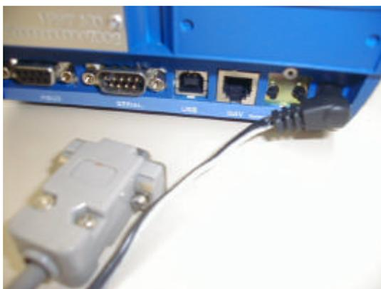
3. Aperte os parafusos do conector do cabo usando uma chave de fenda.
