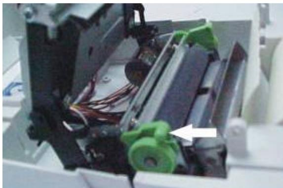
2. Levante a tampa traseira e coloque a bobina em seu alojamento observando a posição correta da mesma.
