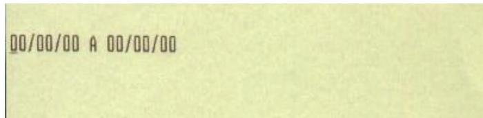
6. Informe as datas inicial e final no formato dd/mm/aa. Cada toque na tecla SELEÇÃO incrementa em uma unidade o dígito na posição do cursor. Quando o valor estiver correto pressione a tecla CONFIRMA; o cursor será posicionado na próxima posição a direita.
