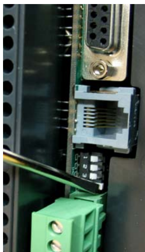
Figura 3.5- Ajustando os Parâmetros de Comunicação da CPU-700
