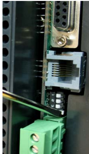
Figura 3.14- Ajustando os Parâmetros de Comunicação da CPU-700
