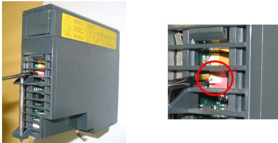
Figura 3.6- Localizando a Rotary Switch da CPU-700. No detalhe: A Rotary Switch.
