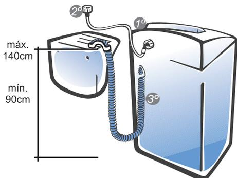
**Nunca emende a mangueira de saída de água em outra mangueira para aumentar o comprimento, pois poderá danificar o sistema interno de saída de água.**
