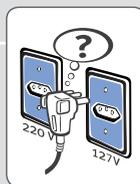
Caso a Lavadora seja ligada na tensão diferente da indicada na etiqueta (127V ou 220V) um sistema automático de reconhecimento da tensão fará com que a Lavadora não funcione, mas não causará nenhum dano ao sistema elétrico da Lavadora. Desconecte o plugue da tomada e verifique se a tensão está correta.
