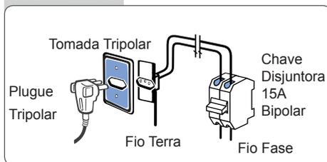
Para a Lavadora 220V (entre duas fases), utilize um disjuntor bipolar de 15A.
