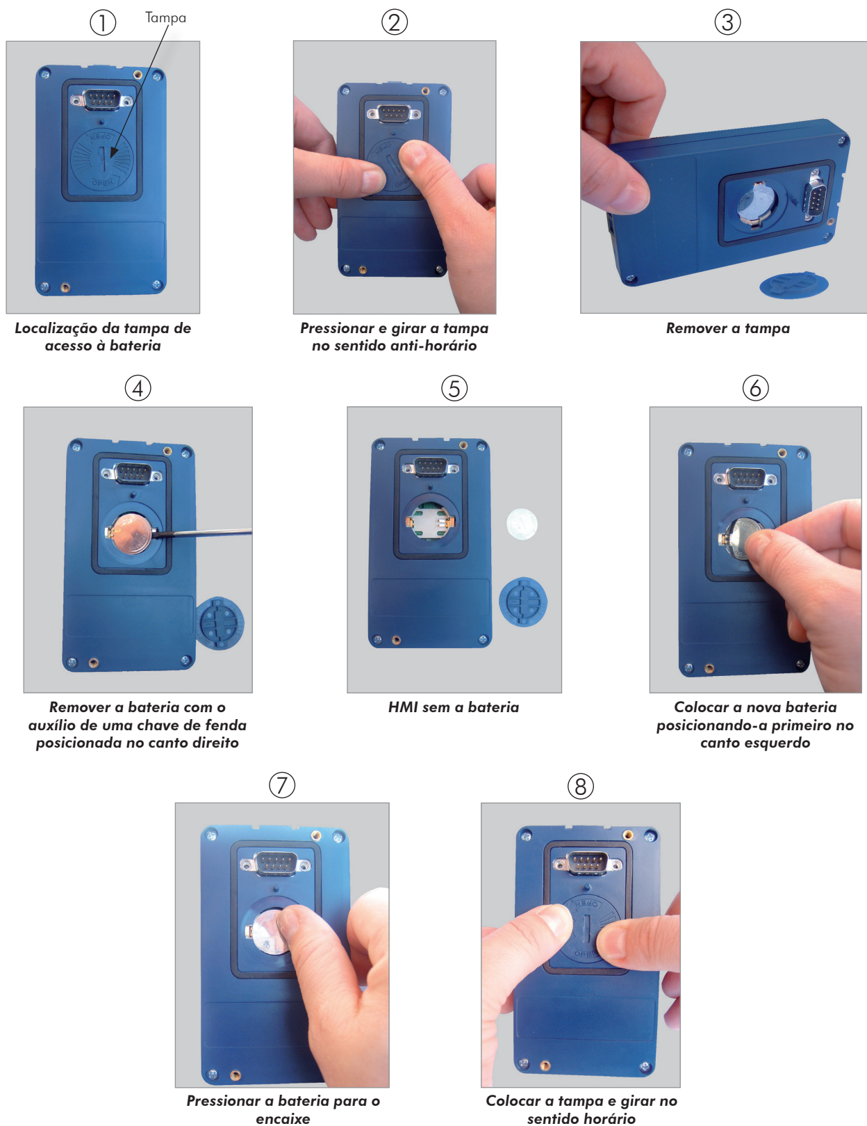
Figura 4.2 - Substituição da bateria da HMI
