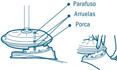
Alinhe o suporte metálico das pás com os furos do motor e faça a fixação com os parafusos, utilizando uma chave de boca nº 8, uma chave Philips e aperte o conjunto até a fixação completa. Evite que as pás sejam pressionadas umas contra as outras durante a montagem, se houver desbalanceamento ou ruído, refaça a montagem.
