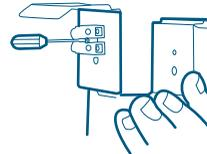
Fixe o conector elétrico no suporte do teto utilizando uma chave de fenda adequada. Prenda no furo de cima (menor).
