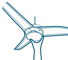
Substitua a lâmpada queimada e/ou limpe a lente de vidro com um pano úmido e recoloca a moldura conforme o item “montagem da luminária”.
