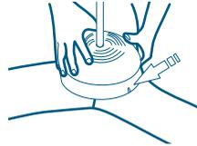
Passa a haste pelo furo da carenagem e desça esta até as pás, observando para que as garras internas da carenagem encaixem nos alojamentos das pás. É necessário aplicar pressão para o encaixe completo da peça.
