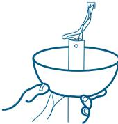
Monte a canopla, passando-a pela haste metálica.
