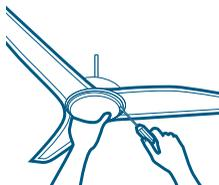
Antes de iniciar a troca das lâmpadas de seu ventilador, certifique-se de que a rede elétrica esteja desligada. Aguarde o resfriamento total da lente de vidro e das lâmpadas.
