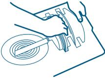
Retire o ventilador segurando-o pelo motor, ele deve sair com facilidade. Nunca aplique força excessiva.
