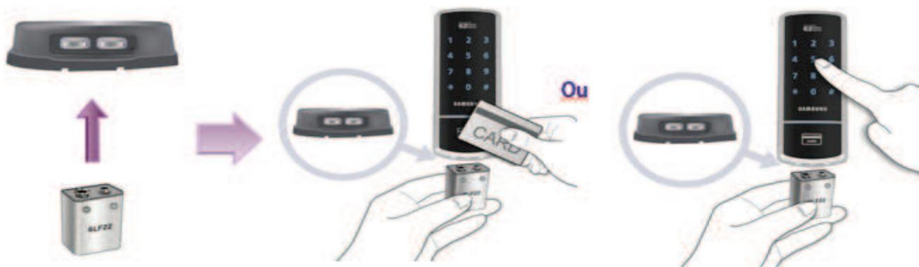
Posicione o Cartão de Proximidade no Leitor de Cartão ou entre com a senha, enquanto a pilha de 9V é conectada ao contato de energia externo da unidade externa.
