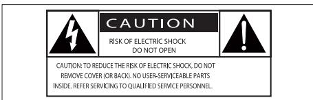
Este "raio" indica a presença de materiais sem isolamento na parte interna do dispositivo, o que pode causar choque elétrico. Não remova a tampa, pois isso pode comprometer a segurança de toda sua família.
