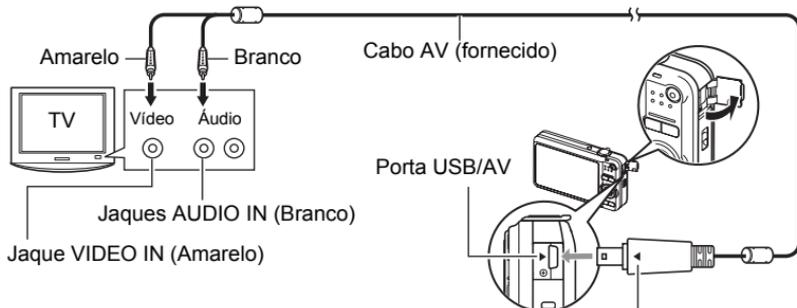
Certifique-se de que a marca ► na câmera esteja alinhada com a marca ◀ no conector do cabo AV e, em seguida, conecte o cabo à câmera.
