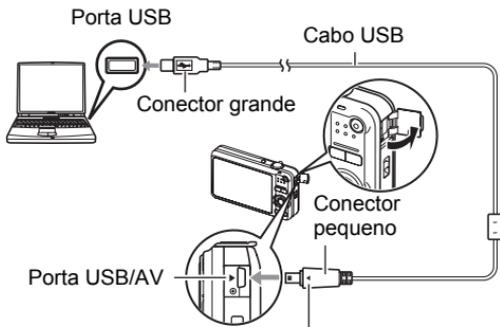
Certifique-se de que a marca ► na câmera esteja alinhada com a marca ◀ no conector do cabo USB e, em seguida, conecte o cabo à câmera.
