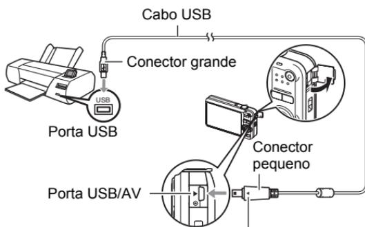
Certifique-se de que a marca ▶ na câmera esteja alinhada com a marca ◀ no conector do cabo USB e, em seguida, conecte o cabo à câmera.
