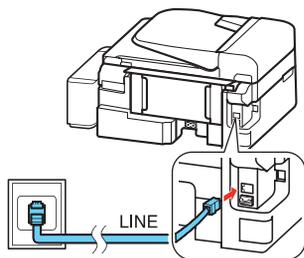
**Observação:** Se você se conectar a uma linha de telefone DSL, é preciso que use um filtro de DSL ou não poderá enviar fax. Entre em contato com o seu provedor de DSL para obter o filtro necessário.
