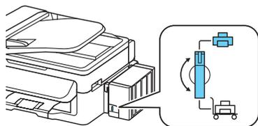
3 Desengate a unidade de tanque de tinta da impressora.
