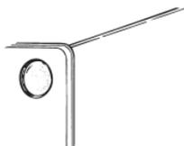
**04** Volte a colocar a cobertura de vidro da lâmpada, rosqueando-a no sentido horário. A cobertura precisa ser colocada corretamente, pois ela protege a lâmpada das altas temperaturas do Forno.
