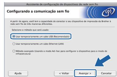
**h** Conecte o computador à impressora temporariamente usando um cabo USB (não incluído).
