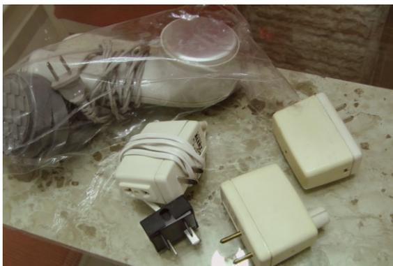
**Figura 88 - Aparelho de massagem utilizado por Mauricio Lima para adaptar aviso vibratório em babá eletrônica**
