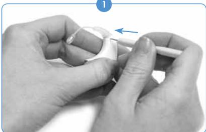
Remova a fonte de energia. Alinhe a extremidade pontiaguda da ferramenta T-Mic 2/Gancho com o buraco do processador com o pino segurando o T-Mic 2/Gancho no Naída CI.
