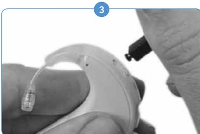
Puxe com cuidado a ferramenta para fora da abertura. O revestimento do microfone deve sair junto com a ferramenta. O revestimento pode ser removido da ferramenta e, então, ser descartado.
