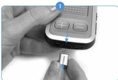
Com o ComPilot desligado, segure-o em uma mão. Com a outra mão, alinhe os três pinos conectores FM com o Europort no ComPilot. Tenha cuidado em assegurar que os pinos receptores FM correspondam ao tamanho e orientação dos orifícios no ComPilot. A falha ao realizar tal tarefa pode causar danos ao receptor FM e/ou ComPilot.
