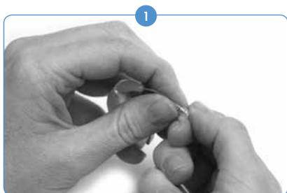
Aperte a extremidade do T-Mic 2 onde seu Revestimento está localizado, com uma mão. Segure com firmeza a porção do microfone T-Mic 2 na outra mão.
