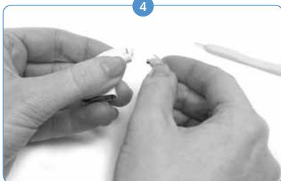
Remova a ferramenta do Naída CI. Aperte suavemente o T-Mic 2/Gancho na parte superior, onde ele se conecta com o processador, e puxe para frente até que ele se separe do processador.
