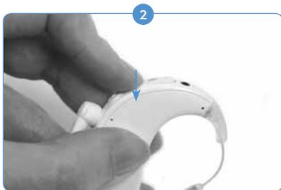
Pressionar suavemente a porção inferior do controle de volume irá diminuir o volume.
