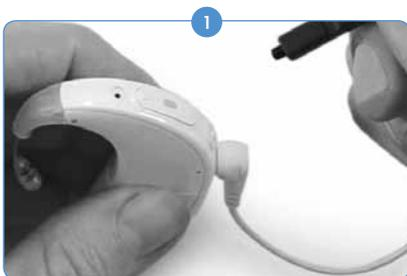
Apertando a ferramenta em uma mão, use a extremidade lisa, sem encadeamentos, para colocar um novo revestimento do microfone na extremidade da ferramenta. O revestimento do microfone é muito pequeno, assim a ferramenta funciona como um guia para substituí-lo de maneira apropriada e fácil.
