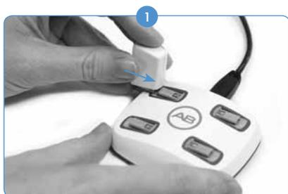
Localize as guias de deslizamento no carregador. Posicione a PowerCel de modo que o contato da pilha fique voltado para baixo para a base do carregador.
