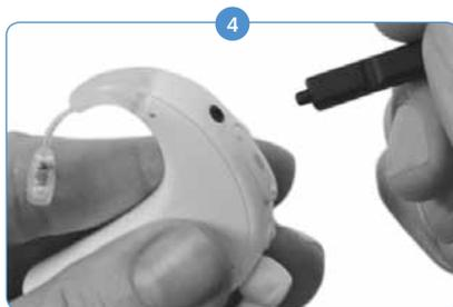
Puxe com cuidado a ferramenta do processador, deixando o revestimento do microfone posicionado corretamente em seu orifício.
