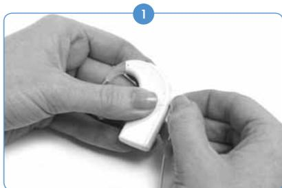
Segure o conector do cabo (o plugue de plástico angulado da direita, não o fio).
