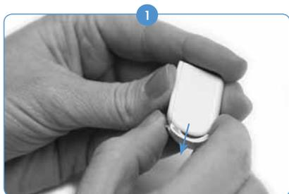
Segurando o Pacote de Pilha de Zinco-Ar em uma mão, empurre gentilmente, mas com firmeza, a alavanca na parte traseira do compartimento da pilha. Isso fará com que o encaixe saia pela parte inferior do compartimento.
