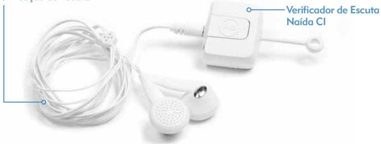
O Naída CI possui um conveniente modo monitor, acessado ao usar o Verificador de Escuta Naída CI e os Fones de Ouvido de Verificação de Escuta. Esse modo permite que alguém com audição normal escute as fontes de entrada de som do Naída CI. Para instruções de como escutar as entradas usando o Verificador de Escuta Naída CI e Fones do Verificador de Escuta, consulte a seção *Escutando o(s) Microfone(s) e as Entradas Auxiliares* de Manual do Usuário.
