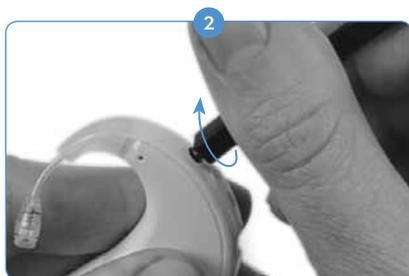
Usando a extremidade da ferramenta com encadeamentos, aperte-a no e através do revestimento do microfone, até que a ferramenta seja capaz de remover o revestimento do microfone.
