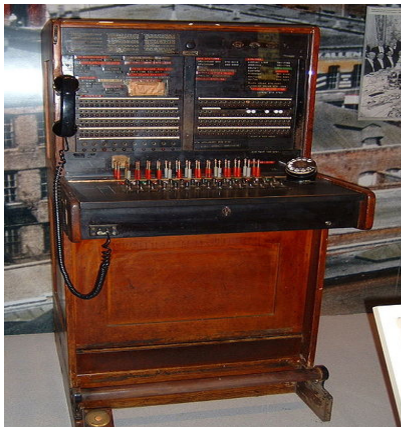
Figura 1.2 - Central de comutação Fonte: site eltamiz
