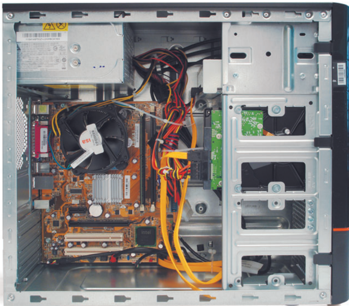
F4. Vista interna do E200. A placa-mãe é uma IPM31, da Digitron.
