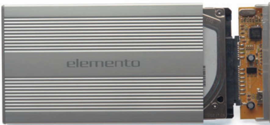
F1. Gaveta Zogis feita de alumínio para melhor dissipação de calor.
