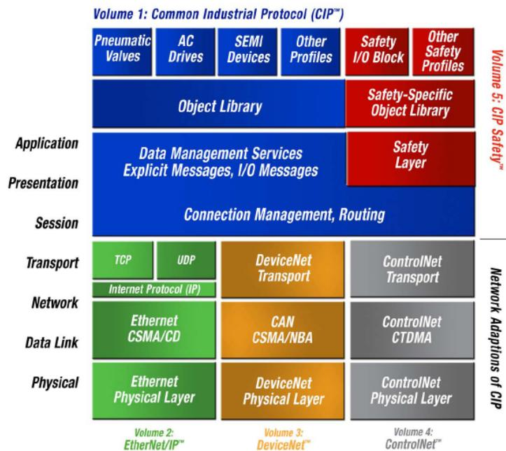
**Figura 1.2:** Estrutura em camadas do protocolo CIP
