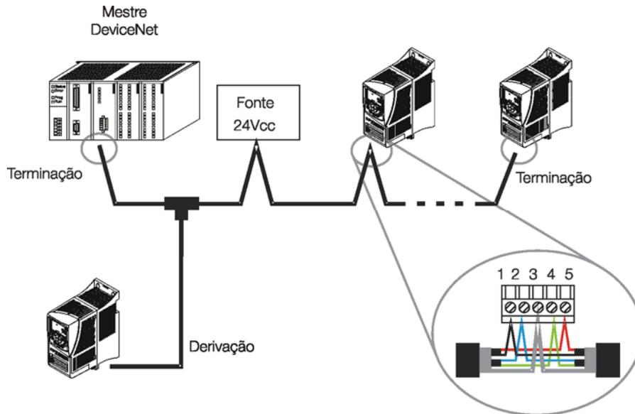
**Figura 3.1:** Exemplo de instalação em rede DeviceNet
