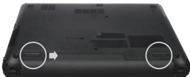
**3** Para maior segurança, após o encaixe da bateria, certifique-se que as travas estejam como na imagem acima. A trava em destaque deve ser movimentada manualmente.
