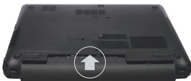
**2** Colocar a bateria em seu compartimento deslizando pelas guias na direção indicada pela seta. A trava emitirá o som de um clique, indicando que a bateria foi encaixada adequadamente
