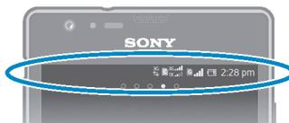
A barra de status permite que você ajuste as configurações básicas do dispositivo como, por exemplo, Wi-Fi®, Bluetooth™, tráfego de dados e som. Também pode abrir o menu de configurações no painel Notificação para alterar outras configurações.
