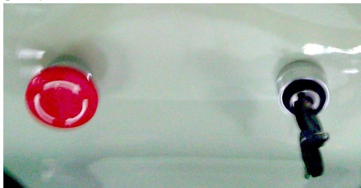
Figura 2.3 Interruptor com Chave e Botão de emergência
