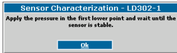
Figura E.15. Estabilizando o Primeiro Ponto
