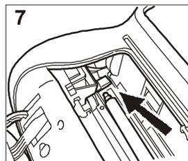
7. Posicione uma extremidade do rolo no pino situado na parte esquerda do telecopiador, como indicado pela seta.
