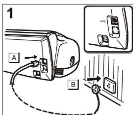
1. A. Introduza o conector do cabo de ligação com a linha telefónica na tomada "LINE" na traseira do telecopiador.
