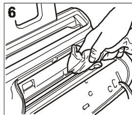
6. Limpe o vidro do scanner óptico usando um **pano humedecido** com um produto específico para limpar vidros e enxugue cuidadosamente.
