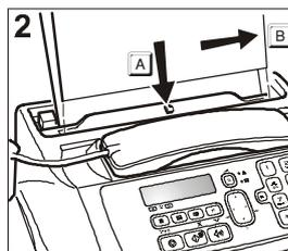
2. Introduza o original no dispositivo de introdução (ADF) com a face a transmitir virada para baixo (A).
