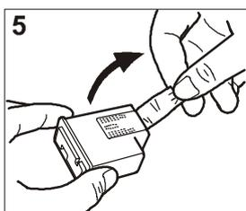
5. Remover o cartucho novo da embalagem e, segurando-o pelos dois lados, remover a película que protege os injectores.
