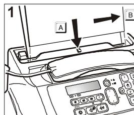
1. Introduza o original no dispositivo de introdução (ADF) com a face a transmitir virada para baixo (A).
