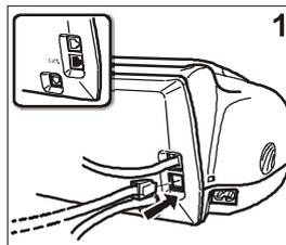
1. Para conectar o telefone de emergência directamente com o telecopiador, remova a tampa que cobre a tomada de conexão à linha externa e, depois, insira o conector do telefone de emergência na tomada.
