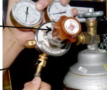
Entrada do gás na máquina, recomenda-se o uso de abraçadeiras metálicas para fixar e evitar vazamentos.
