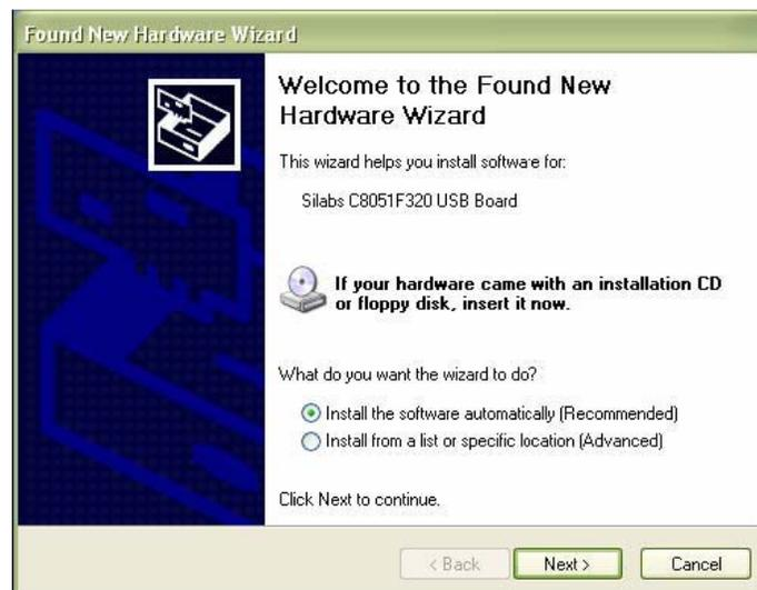
Verifique se o disco do programa ainda se encontra no leitor de CD-ROM do PC. Selecione a instalação “recomendada” e siga os comandos na tela para completar a instalação do dispositivo. Se não for a primeira vez que o VB300 é conectado à entrada USB em questão, o processo de instalação do dispositivo será pulado automaticamente.
