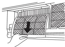
3. Após retirar o filtro da unidade interna, limpe o FILTRO DE AR, utilizando para isto um aspirador de pó ou lavando-o com água; depois deixe-o secar em local seco.
