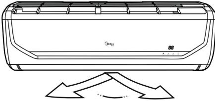
Regular manualmente os defletores verticais para alterar a direção do fluxo de ar para esquerda ou para direita, movendo a(s) alavanca(s) situada(s) na extremidade esquerda (ou direita) dos defletores (esta posição poderá variar conforme o modelo).
