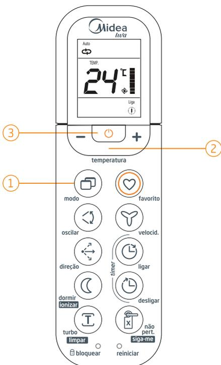
Quando a unidade for configurada no modo AUTOMÁTICO (Auto), os modos REFRIGERAÇÃO (Frio), AQUECIMENTO (Calor - versões quente/frio) ou VENTILAÇÃO (Vent.), são selecionados automaticamente conforme a temperatura ambiente e a temperatura selecionada no controle remoto.
